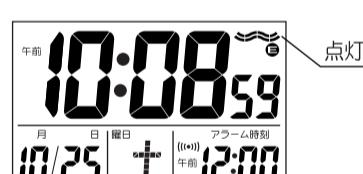
福島送信所の標準電波を受信した場合は、Eマークが点灯し、九州送信所の標準電波を受信した場合は、Wマークが点灯します。
