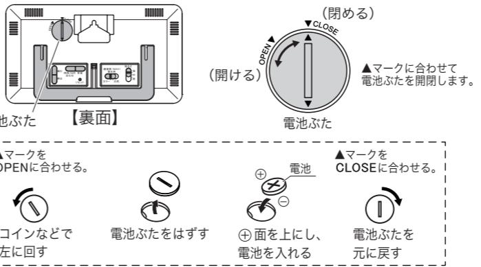
・電池は停電などが発生した場合、停電から復帰した後で正しい時刻を表示するため、内部の時刻情報を更新するバックアップ用電池です。
