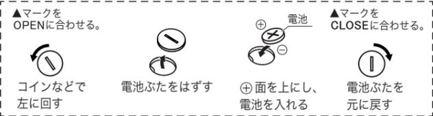
●電池は停電などが発生した場合、停電から復帰した後で正しい時刻を表示するため、内部の時刻情報を更新するバックアップ用電池です。
