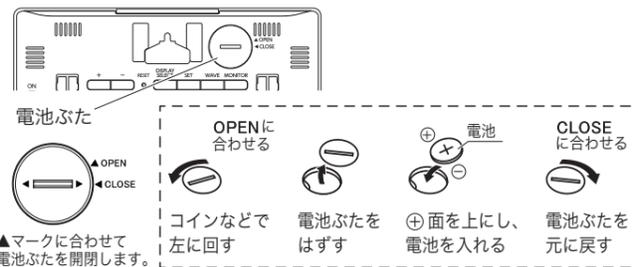
電池は停電などが発生した場合、停電から復帰した後で正しい時刻を表示するため、内部の時刻情報を更新するバックアップ用電池です。(バックアップ用電池で稼働中は、時刻等の表示および電波の受信は行いません。)
