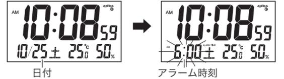
(2)点滅中に「⑤戻る(<)ボタン/進む(>)ボタン」を押してアラームを合わせる
