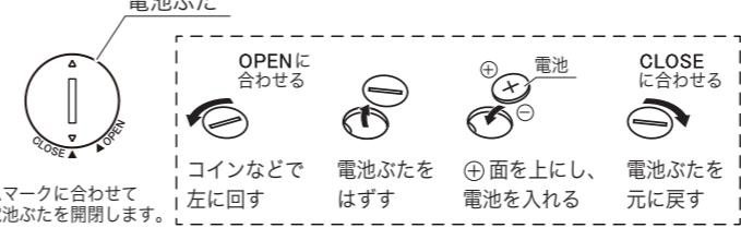
電池は停電などが発生した場合、停電から復帰した後で正しい時刻を表示するため、内部の時刻情報を更新するバックアップ用電池です。(バックアップ用電池で稼働中は、時刻等の表示および電波の受信は行いません。)
